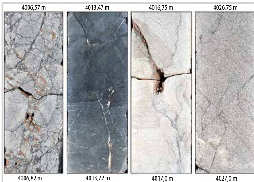
Hình 17. Hình mẫu lõi phụ tập G20 của giếng khoan LDX-3X (đường kính ~ 10 cm). Hình thể hiện một số khoáng mẫu lõi bị dập vỡ trong quá trình lấy và gia công mẫu đồng thời quan sát thấy có tồn tại các nứt nẻ giống như lỗ rỗng vug. Có nhiều vi khe nứt/khe nứt, nhưng hầu hết bị lấp đầy bởi calcite và zeolite (mũi tên màu đỏ).
